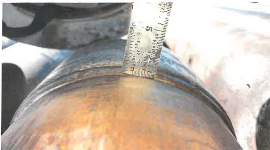
Рис. 4. Выявление термического растрескивания на самых ранних стадиях возможно по выраженной микротрещиноватости.
