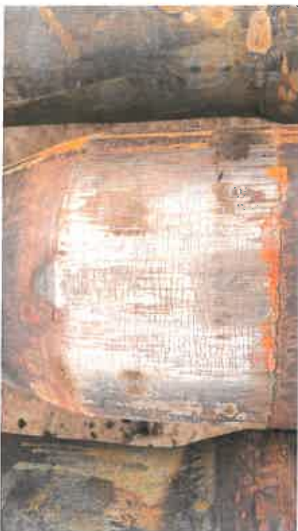
Рис. 4. Выявление термического растрескивания на самых ранних стадиях возможно по выраженной микротрещиноватости.
